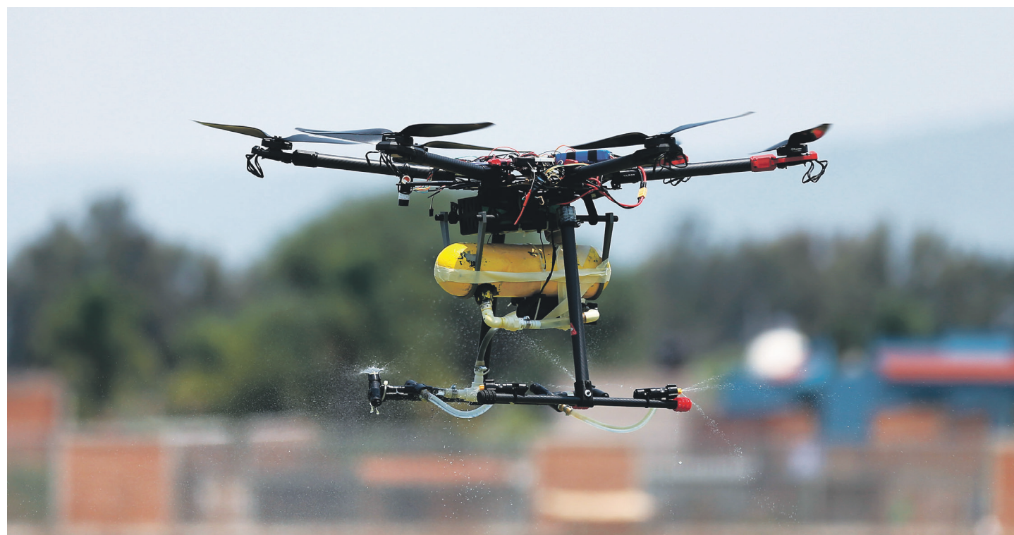
Este dron permite esparcir granos fertilizantes y fumigar en zonas de difícil acceso. / FOTO: ABRAHAM ARÉCHIGA
