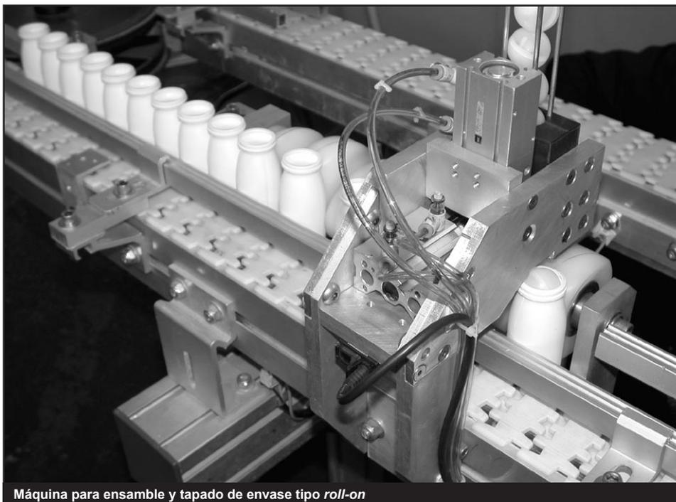
Máquina para ensamble y tapado de envase tipo *roll-on*
