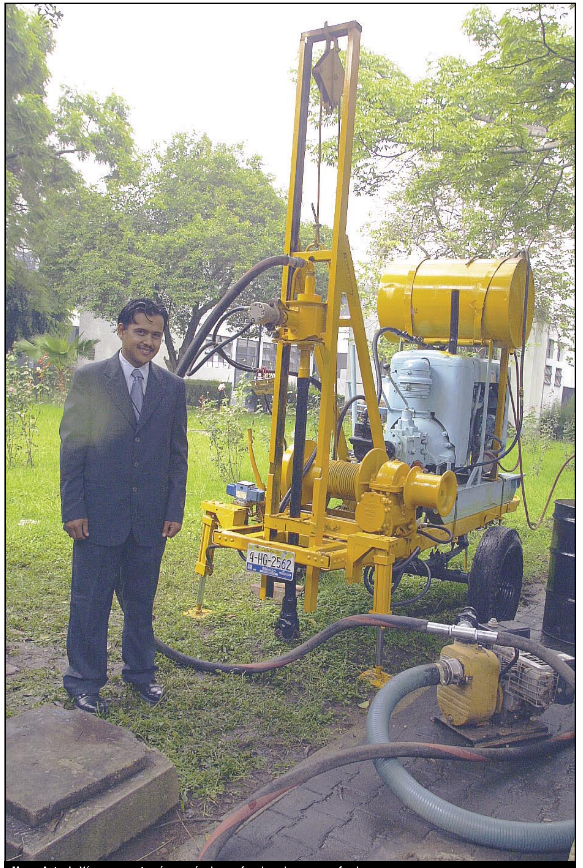
Marco Antonio Vázquez construyó una máquina perforadora de pozos profundos
